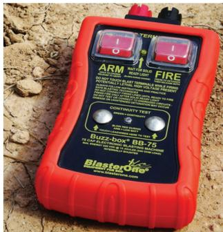
**Exploseur à grande capacité de décharge** Le Buzz-Box™ BB-75 est un exploseur évolué à grande capacité de décharge énergétique. C'est un dispositif qui opère entre 320 VCC @ 10 joules (minimum) avec une détonation à 340 VCC @ 13 joules (maximum). Il est équipé d'un circuit de testage en pont intégré et de plusieurs autres dispositifs de sécurité. Il a la capacité d'allumer jusqu'à 120 cartouches NxBurst™ raccordées en série.
