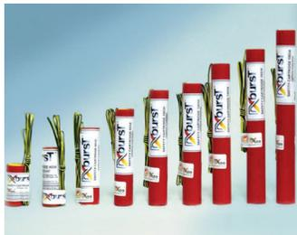
Les cartouches NXburst™ 34mm sont utilisées pour la démolition du béton; l'élargissement des tunnels et conduits, les excavations de tranchées ou autres travaux sur des sites sensibles. Les cartouches NXburst™ 34mm sont offertes avec des densités de chargement de 20 à 180 grammes en incrément de 20 grammes.
