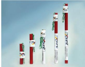
Les cartouches RockPoppers NXburst™ sont utilisées pour fragmenter les petits rochers de taille allant jusqu'à un mètre cube (utilisées surtout pour réduire la taille des roches destinées aux concasseurs); pour le nettoyage des sédiments dans les réservoirs et silos et pour les petits travaux de démolition. Elles nécessitent des trous de chargement d'un diamètre de 14 à 16 mm pouvant être forés avec une perceuse à percussion manuelle.
