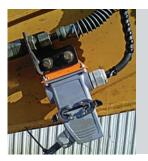
Connexion rapide- En cas de besoin, la foreuse MDA est entièrement démontable grâce à deux broches, deux déconnexions rapides hydrauliques et une déconnexion rapide électrique.
