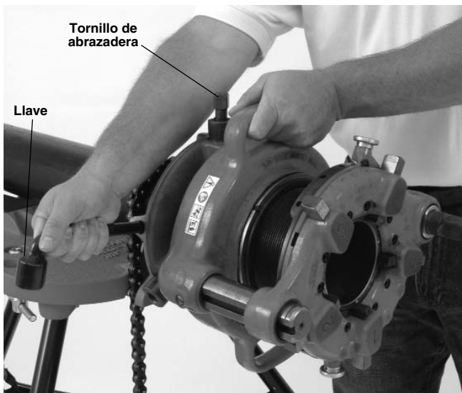
Figura 6 – Cómo apretar el portaherramientas
