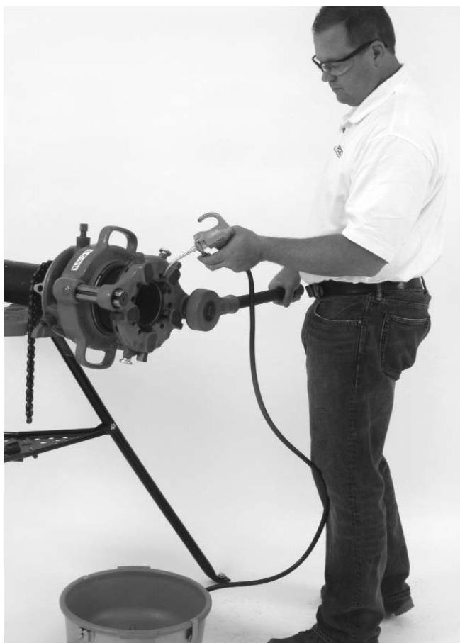
Figure 7 – Utilisation de la clé à cliquet D-1440
