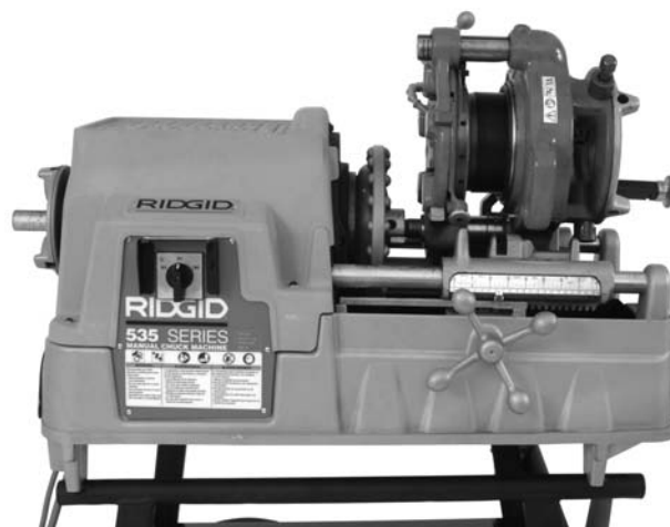
Figure 17 – Fileteuse démultipliée en montage direct avec 535
