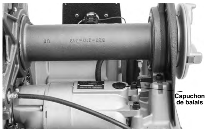
Figure 34 – Retrait du capot et remplacement des balais
