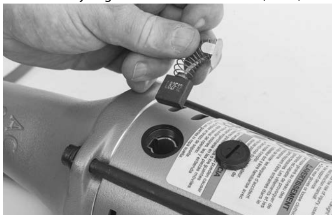
Figuur 13 – Motorborstels inbouwen
