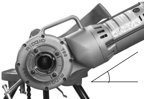
Slika 6 – Potporna stega postavljena sa električnom nareznicom 700 malo iznad horizontalnog položaja
