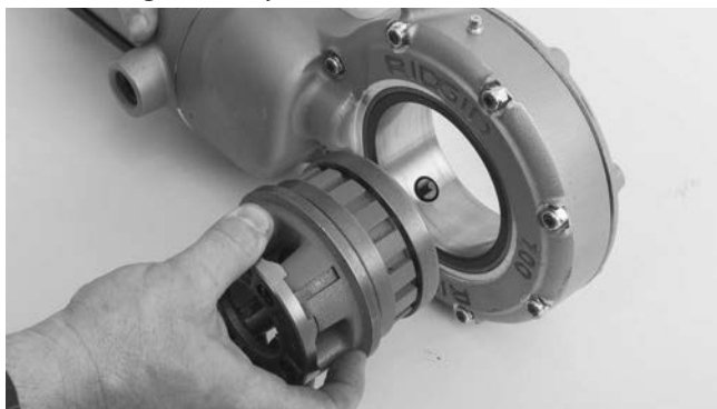
Figur 4 – Montering af skærehoveder i det elektriske rørdrev 700
