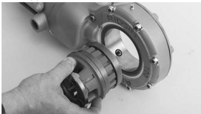
Εικόνα 4 – Τοποθέτηση φιλιέρων στον ηλεκτρικό βιδολόγο 700
