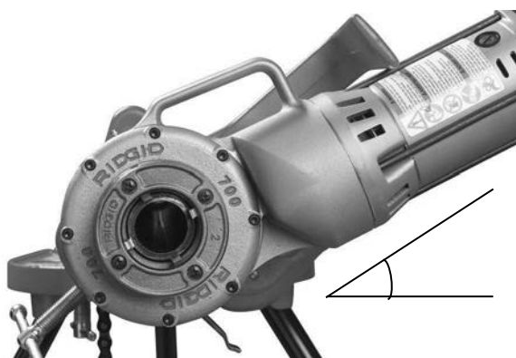
Figura 6 – Staffa di supporto posizionata con la Filettratrice 700 leggermente in alto orizzontalmente
