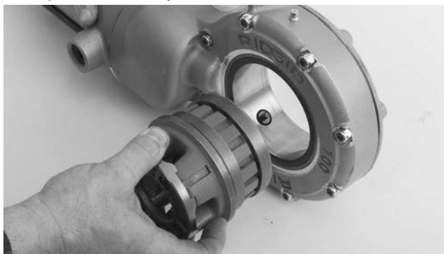
Obrázek 4 – instalace závitorezných hlav do elektrické závitnice 700
