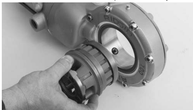
Obrázok 4 – Inštalácia závitorezných hláv do elektrického pohonu 700
