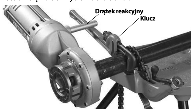
Rysunek 7 – Gwintowanie z użyciem klucza do rur jako ramienia podporowego.
