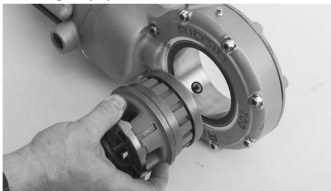
Slika 4 – Stavljanje narezne glave u električnu nareznicu 700
