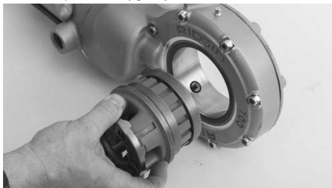
Slika 4 – Postavljanje nareznih glava u nareznu glavu 700
