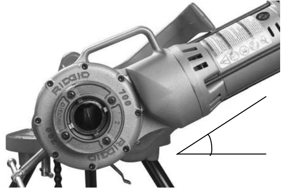
Şekil 6 – Destek Kolu 700 Elektrikli El Paftası Yatay Olarak Hafifçe Yukarıda Olacak Şekilde Konumlandırılmış
