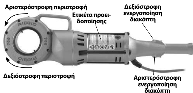
Εικόνα 3 – Θέση του διακόπτη για περιστροφική κατεύθυνση
