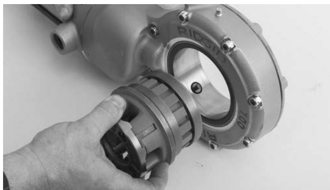
Slika 4 – Vgradnja rezalnih glav v električni pogon 700-I
