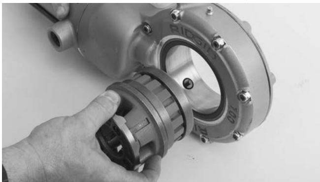
Figur 4 – Installere gjengehoder i 700 Power Drive drivenhet
