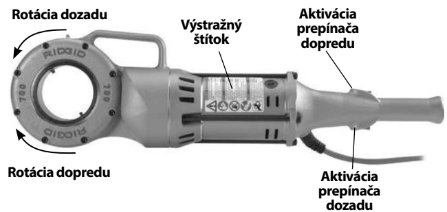
Obrázok 3 – Poloha prepínača pre smer otáčania
