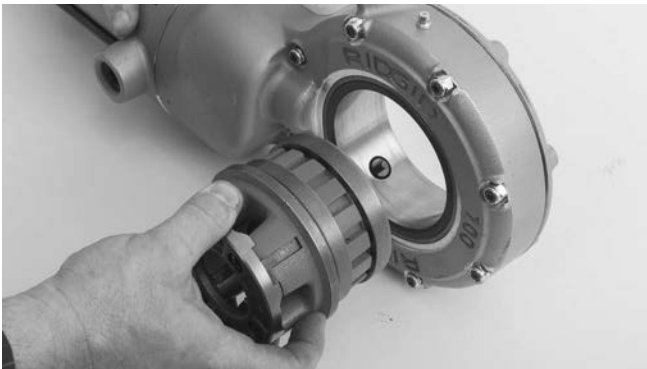
Şekil 4 – Pafta Kafalarının 700 Elektrikli El Paftasına Takılması
