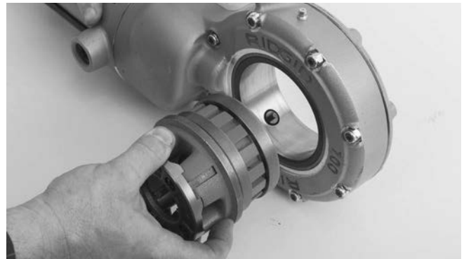
Рис. 4 – Установка резьбонарезных головок в силовой привод модели 700
