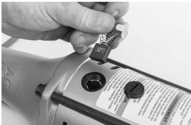
Figura 13 – Colocación de la escobilla
