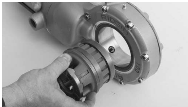
Figura 4 – Instalar cabeças de rosca no Propulsor 700
