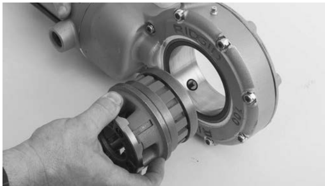
Abbildung 4 – Einsetzen der Schneidköpfe in den Kraftantrieb 700
