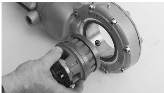
Figur 4 – Montera gönghuvuden i drivenheten 700 Power Drive
