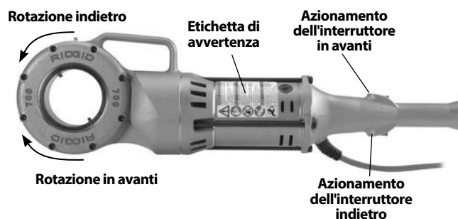
Figura 3 – Posizione dell'interruttore per la Direzione di rotazione
