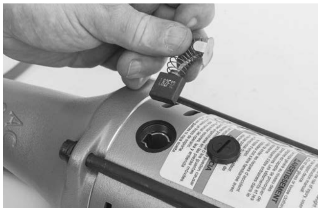
Figura 13 – Installazione della spazzola
