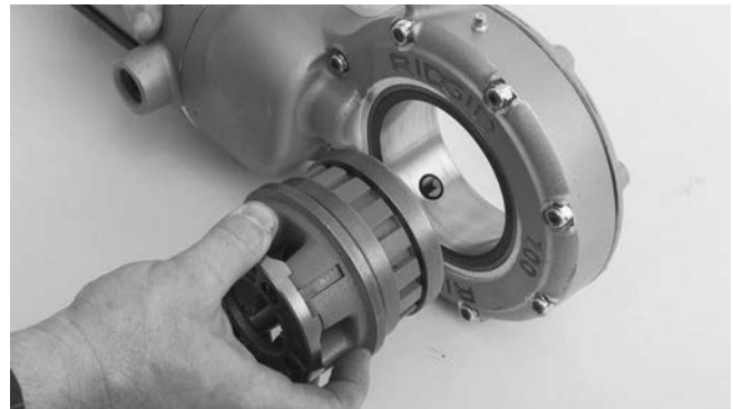
Figura 4 – Installazione delle Teste portapettini nella Filettatrice 700
