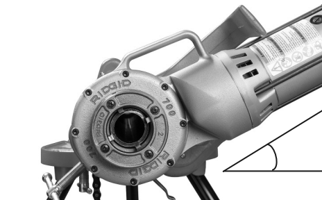
Figura 4 – Staffa di supporto posizionata con il Motore 700 leggermente in alto orizzontalmente Ilustracja 4 – wspornik ustawiony z napędem mechanicznym nieco powyżej pozycji poziomej Рис. 4 – Струбцина-фиксатор с силовым приводом 700, который расположен немного выше горизонтали
