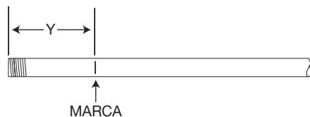
1. Seleccione el tamaño y tipo de tubo portacables a doblar. Determine la altura del codo y el ángulo de doblez.
