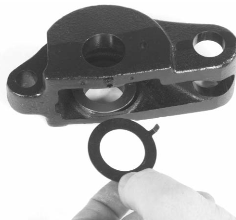
Figura 18 – Manera en que se inserta la arandela con lengüeta
