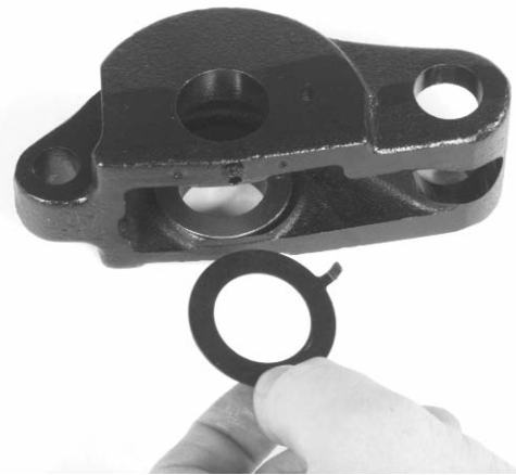
Figure 18 – Introduction de la rondelle de butée à ergot
