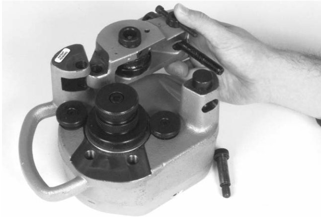
Figure 15 – Retrait de la vis d'avancement
