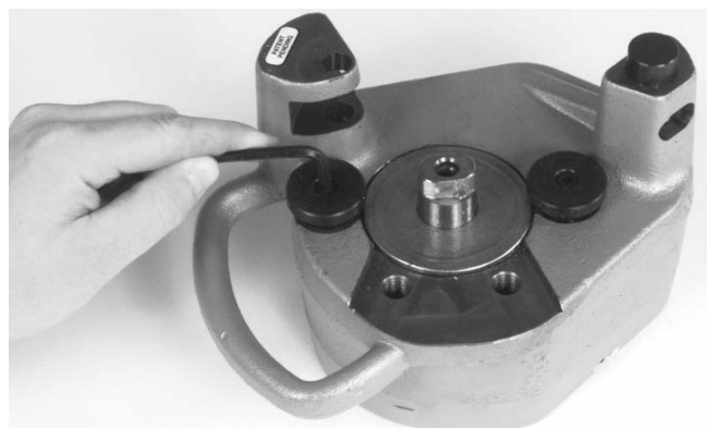
Figura 17 – Instalación del cojinete estabilizador para cobre
