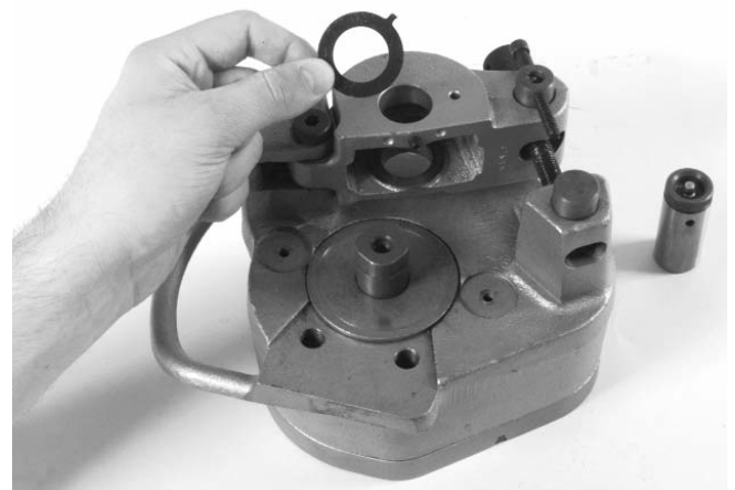
Figura 10 – Colocación de la arandela de empuje con lengüeta
