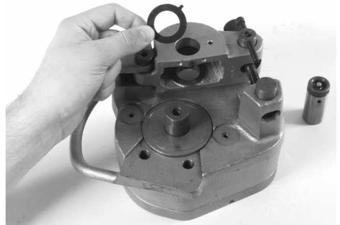
Figure 10 – Positionnement de la rondelle de butée
