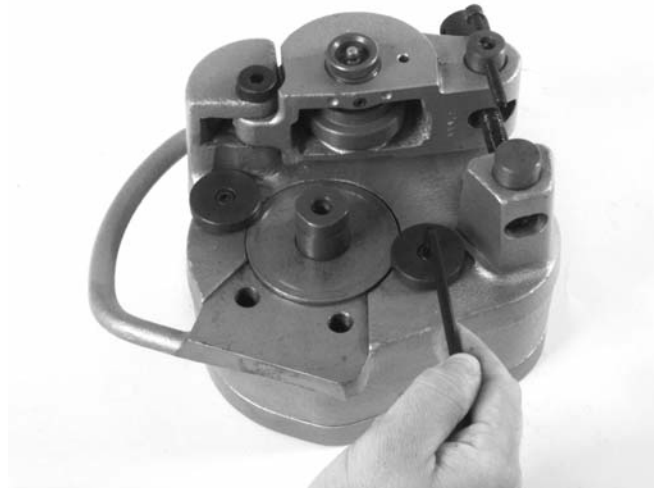
Figura 13 – Instalación de los estabilizadores
