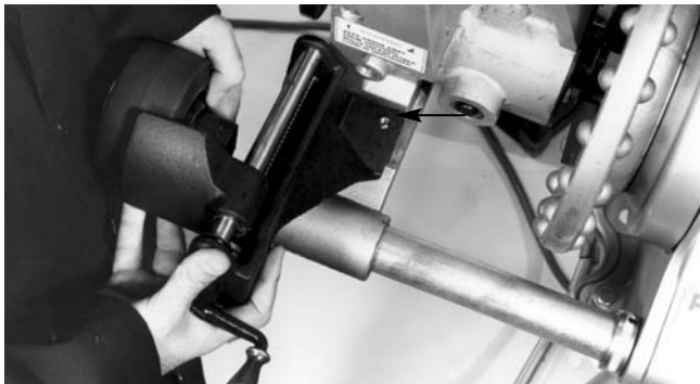
Figura 22 – Alinee los agujeros de los tornillos del brazo de montaje con los agujeros para los tornillos en la base de la ranuradora
