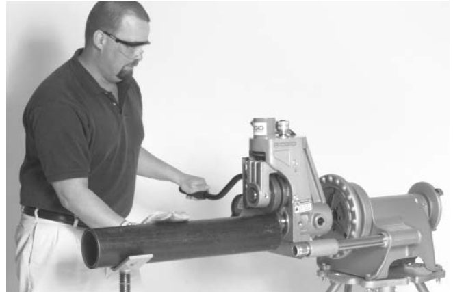
Figura 15 – Operario ejerce presión hacia el lado opuesto a él, con su mano derecha sobre el tubo, cuando el Accionamiento Propulsor está en la modalidad de FOR (adelante).
