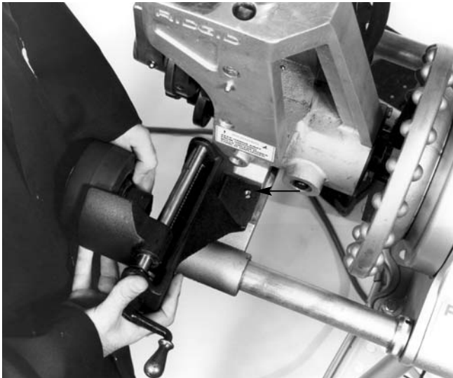
Figure 22 – Alignement des trous de fixation du support sur ceux de l'embase
