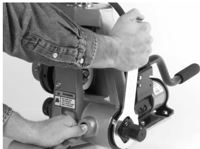
Figure 19 – Engagement de la broche de verrouillage axial et retrait de l'écrou de retenue de l'arbre d'entraînement.
