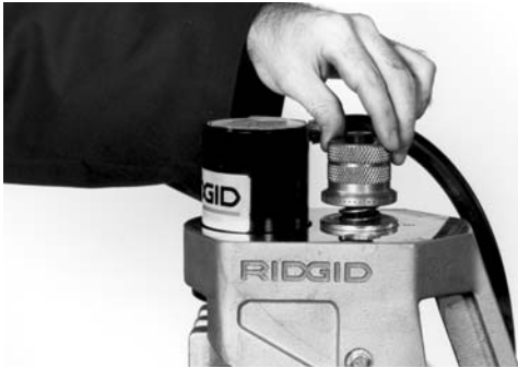
Figure 14 – Détail de la mollette de réglage de profondeur ramenée, laissant un vide entre le bas de la mollette et le bâti
