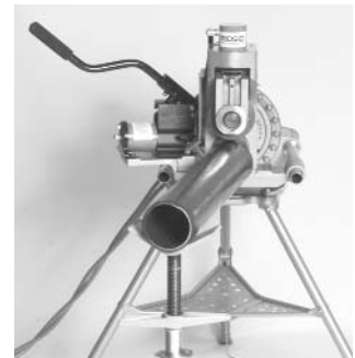
Figure 13 – Décalage du tuyau avec la 918 en position REV (marche arrière)
