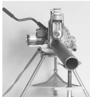
Figure 12 – Décalage du tuyau avec la 918 en position FOR (marche avant)
