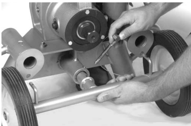
Figure 3 – Retrait de l'essieu de transport
