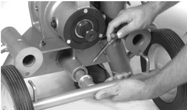
Figura 24 – Montaje de la Ranuradora al carro de transporte No. 32
