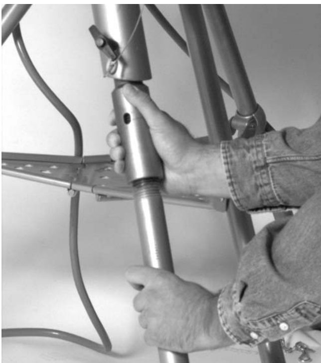
Figura 6 – Ajuste de las patas para nivelar la Ranuradora
