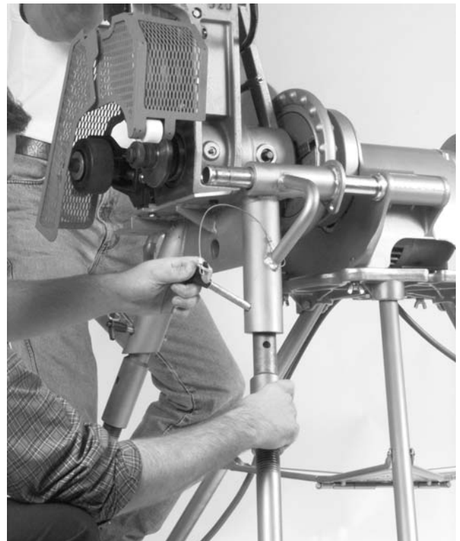
Figura 23 – Extracción de las patas, fuera de la base de la máquina
