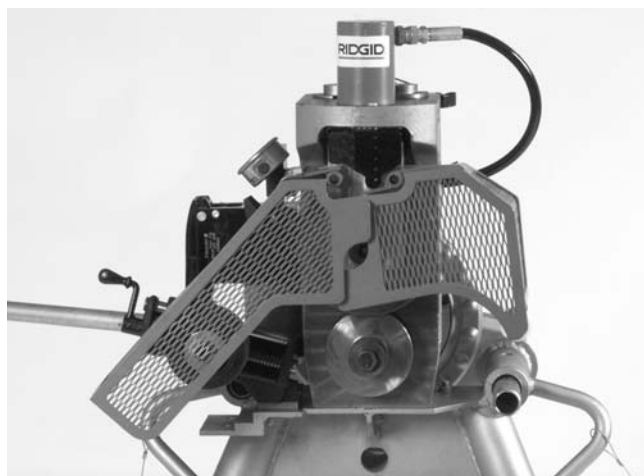
Figure 13 – Carters en position ouverte
