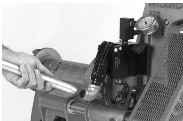
Figure 8 – Installation du levier de pompe
