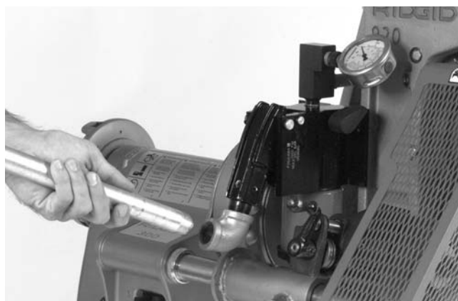
Figura 8 – Instalación de la manivela de la bomba
