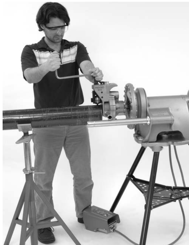
Figura 12 – Postura correcta del operario para hacer funcionar la Ranuradora a Rodillos
