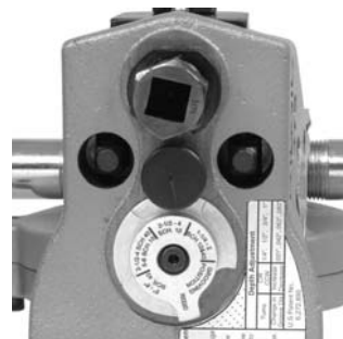
Figure 15A – Amenez la graduation applicable de la jauge sous de la tête de la vis de réglage
