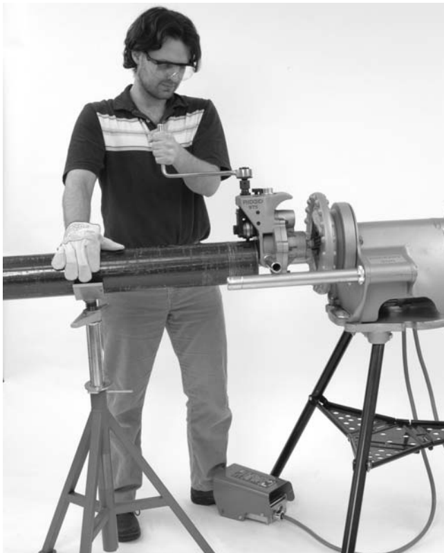
Figura 13 – El operario ejerce leve presión sobre el tubo, acercándolo hacia él, para mantener una buena trayectoria
