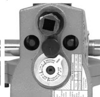
Figura 15B – Indicador en posición de ranurado
