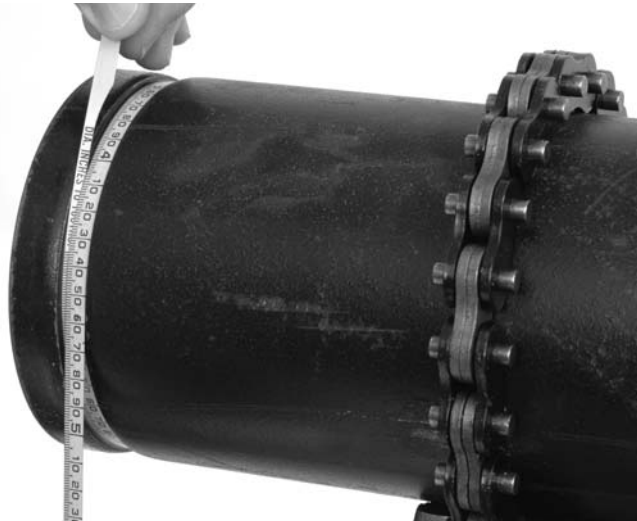
Figura 16 – Medición del diámetro de la ranura con una cinta mide-diámetros
