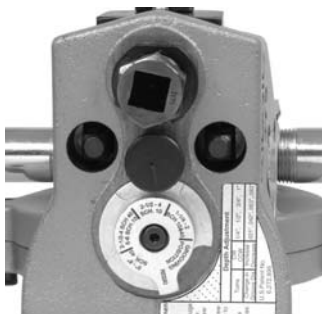
Figura 10A – Coloque la marca correcta del indicador bajo la cabeza del tornillo de ajuste
