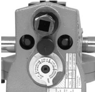
Figure 10A – Amenez la graduation applicable de la jauge sous de la tête de la vis de réglage
