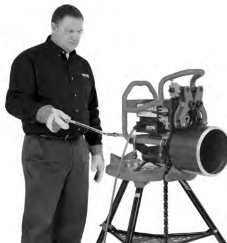
Figura 20C – Operación de biselado (biseladora fija/tubo en rotación)
