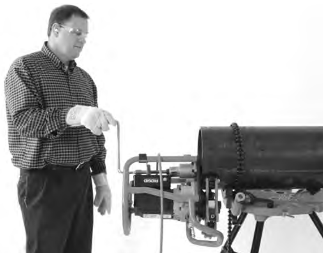
Figura 20B – Operación de biselado (pieza fija/biseladora móvil)
