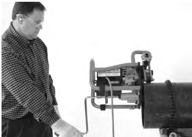
Figura 20A – Operación de biselado (pieza fija/biseladora móvil)
