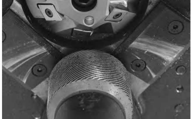
Figure 22 – Nettoyage du moletage du galet d'entraînement
