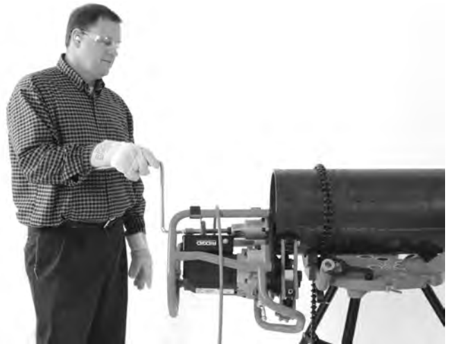
Figure 20B – Biseautage en cours (pièce fixe/machine mobile)
