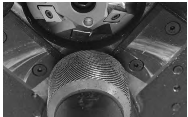
Figura 22 – Superficie moleteada del rodillo de mando, limpia
