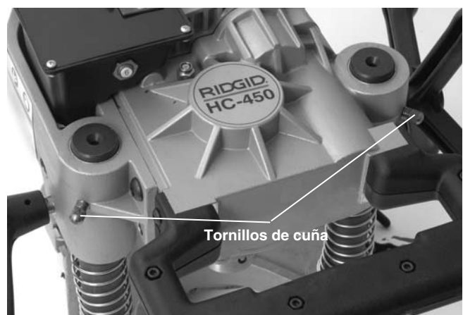
Figura 13 – Ajuste de los tornillos de cuña
