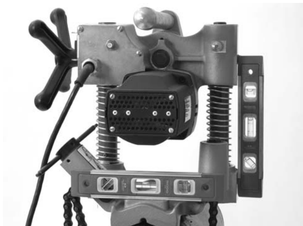
Figure 10 – Mise de niveau de la HC-300
