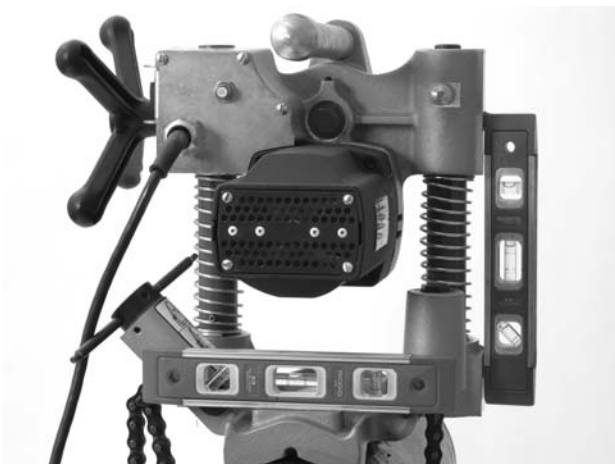
Figura 10 – Nivelación de la HC-300
