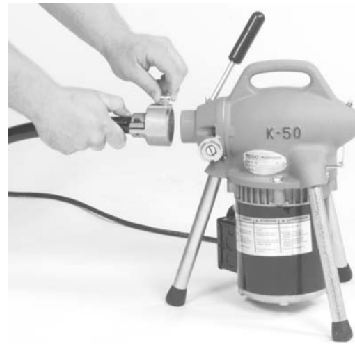
Figure 2 – Montage du guide-câble arrière
