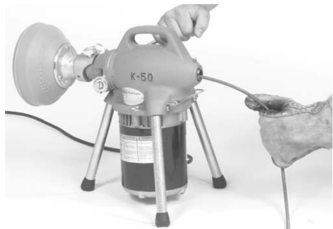
Figura 5 – Acoplamiento del adaptador para el cable
