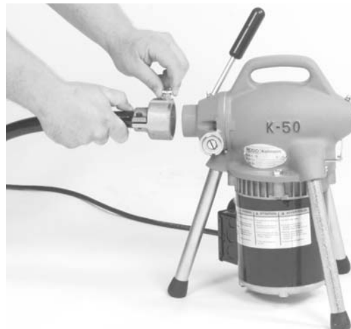
Figura 2 – Acoplamiento de la manguera guía trasera
