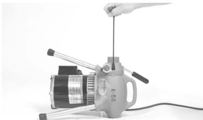
Figura 10 – Extracción de los tornillos de cabeza de cubo
