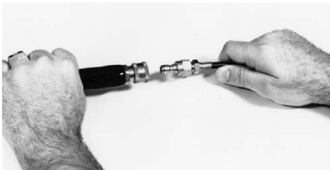
Figure 3 – Raccordement du flexible pression au dégorgeoir
