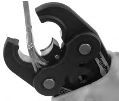
Figure 13 – Nettoyage des axes d'une mâchoire MegaPress
