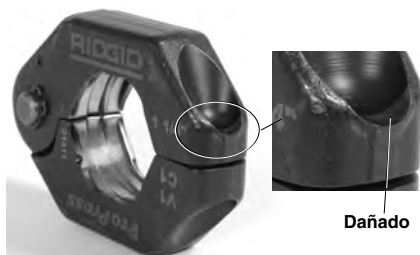
Figura 11 – Cavidad dañada en el aro
