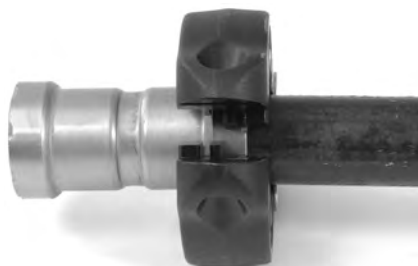
Figure 10 – Ouverture de la bague MegaPress et engagement sur raccord
