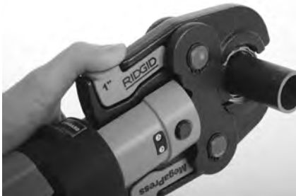
Figura 8 – Apertura de las mordazas MegaPress para colocarlas sobre el acoplador
