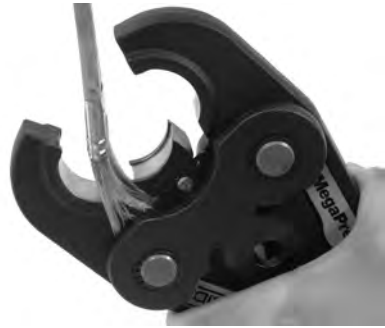
Figure 13 – Nettoyage des axes d'une mâchoire MegaPress
