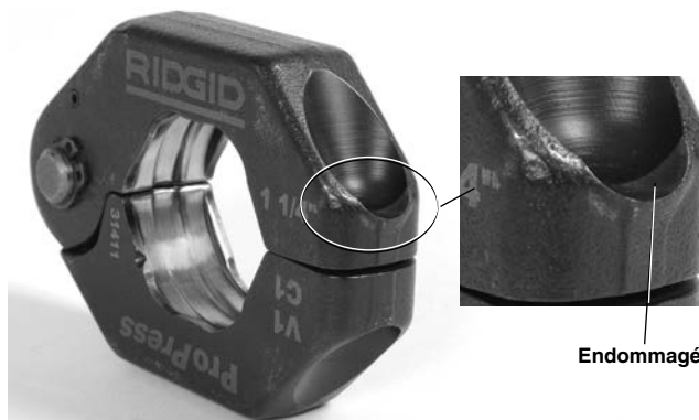
Figure 13 – Logement de bague endommagé
