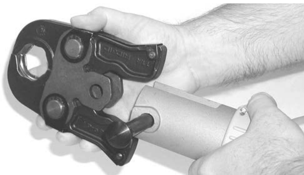
Figure 5 – Retrait de la broche de montage de la sertisseuse
