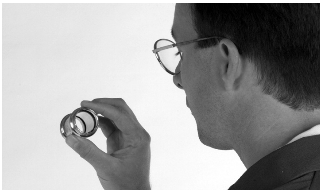
Figure 6A – Inspection d'un raccord ProPress selon les consignes du fabricant
