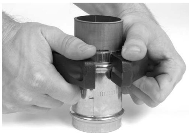
Figura 8 – Montaje del aro sellador en el acoplamiento
