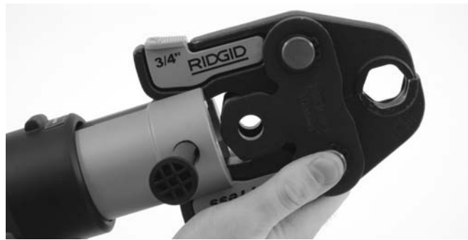
Figure 5 – Glissement de l'accessoire dans l'appareil
