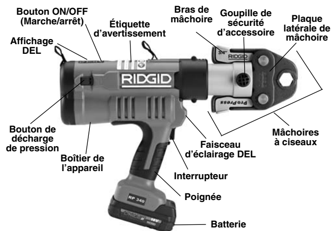
Figure 1 – Sertisseuse RP 340 et mâchoires
