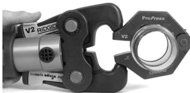
Figura 9 – Montaje del accionador en el aro sellador
