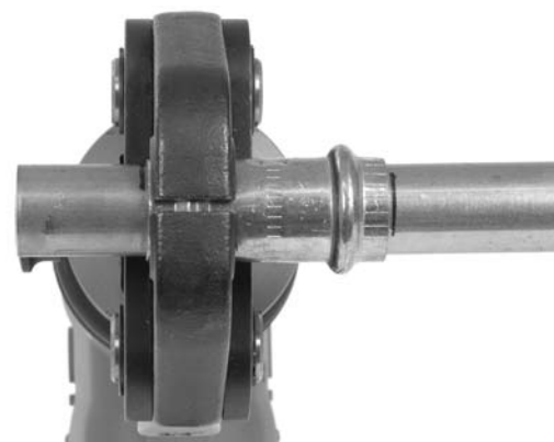
Figura 7 – Selladora RP 340 en posición perpendicular al tubo
