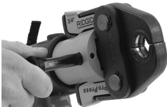
Figure 4 – Goupille de sécurité d'accessoire complètement ouverte
