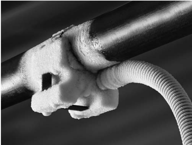
Figura 9 – Cabezal congelado contra la cañería
