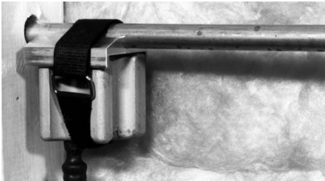
Figura 7 – Cabezal de congelación y adaptador adosados con correa Velcro
