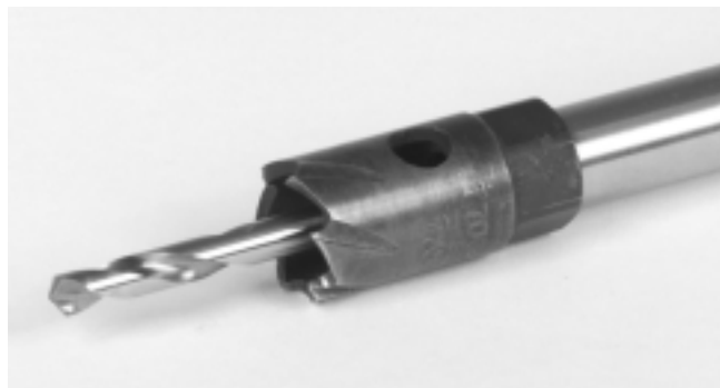
Figure 5 – Installation de la mèche pilote
